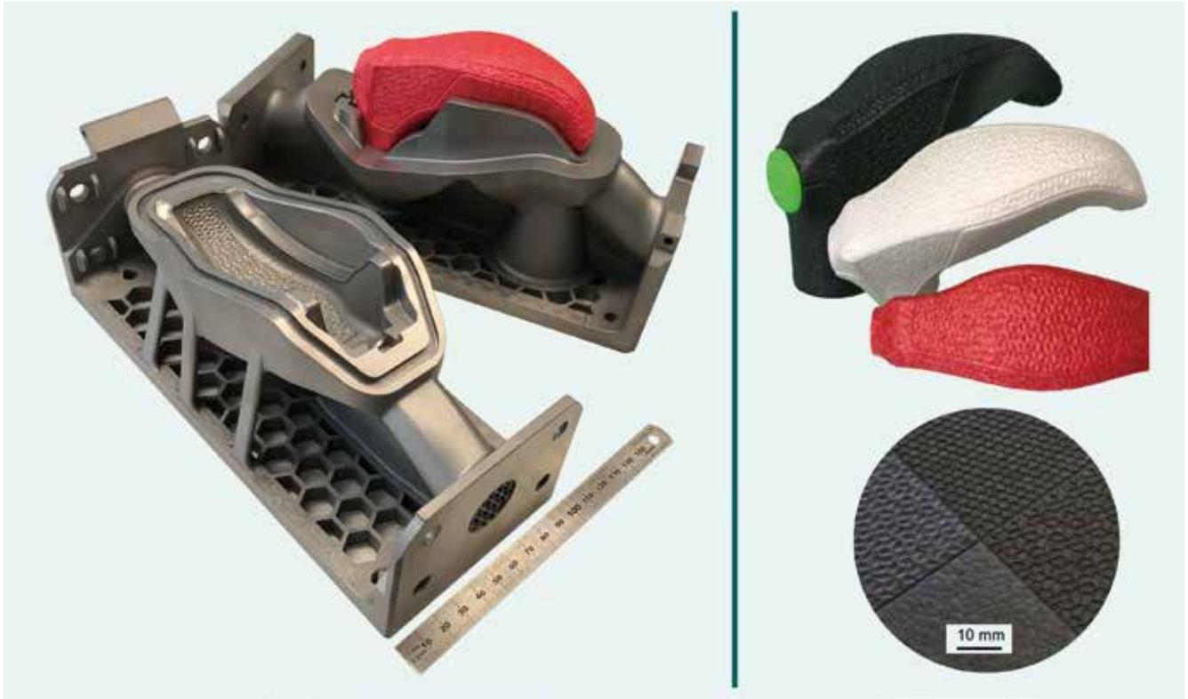
Additiv erstellte Werkzeuge ermöglichen durch funktionalen Leichtbau die Herstellung filigraner Formteile mit anspruchsvollen Oberflächen bei stark reduziertem Energieverbrauch. Als Demonstrator dient hier ein Gehstockgriff mit (nicht sichtbarem) Einleger (© Hofmann)
