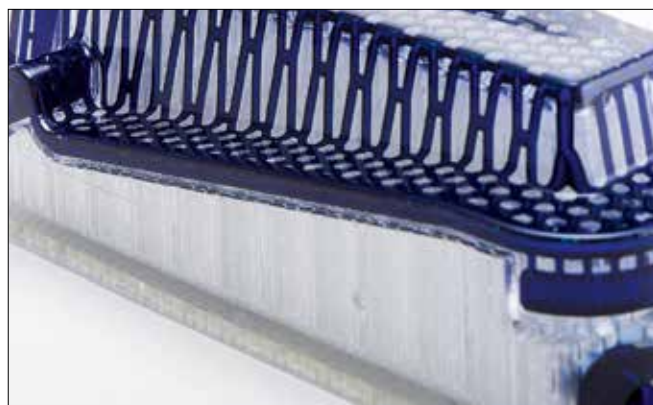
▲ Die Netzkühlung 2 mm unterhalb der Werkzeugoberfläche ermöglicht das variotherme Temperieren von großen Werkzeugflächen, bei der Verarbeitung von Organoblechen.
